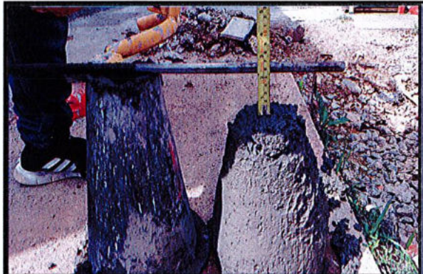
ENSAYO DE ASENTAMIENTO (CONO DE ABRAMS)
