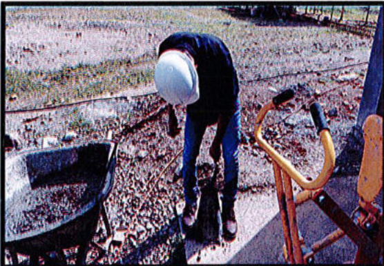
ENSAYO DE ASENTAMIENTO (CONO DE ABRAMS)
