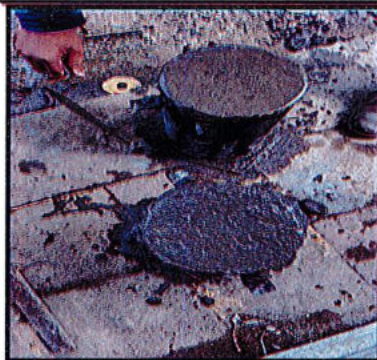
Foto No 5. Toma de muestras testigos de resistencia de vigas aéreas
