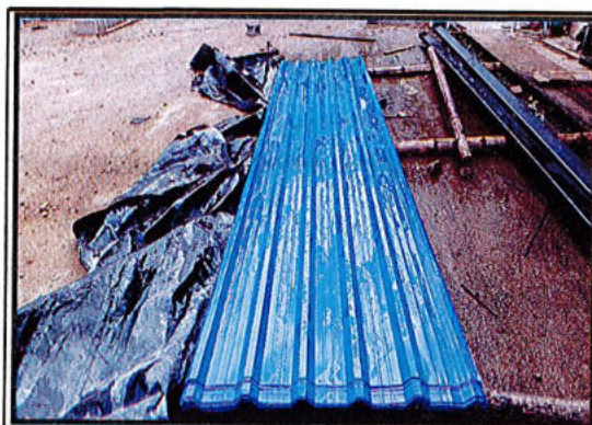
Cubierta termo acústica tipo sándwich
