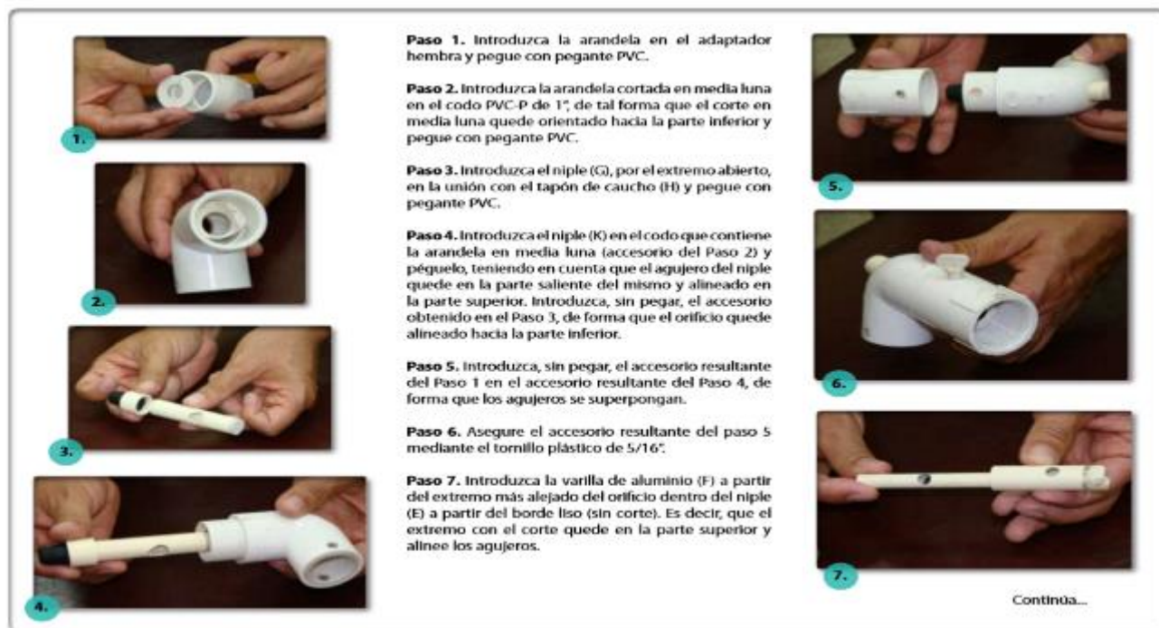
Figura 29. Montaje de la válvula flotador de la recámara dosificadora.
