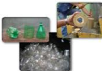
Figura 36. Material de soporte para las bacterias en los reactores metanogénicos (trozos de guadua o trozos de botellas no retornables).
