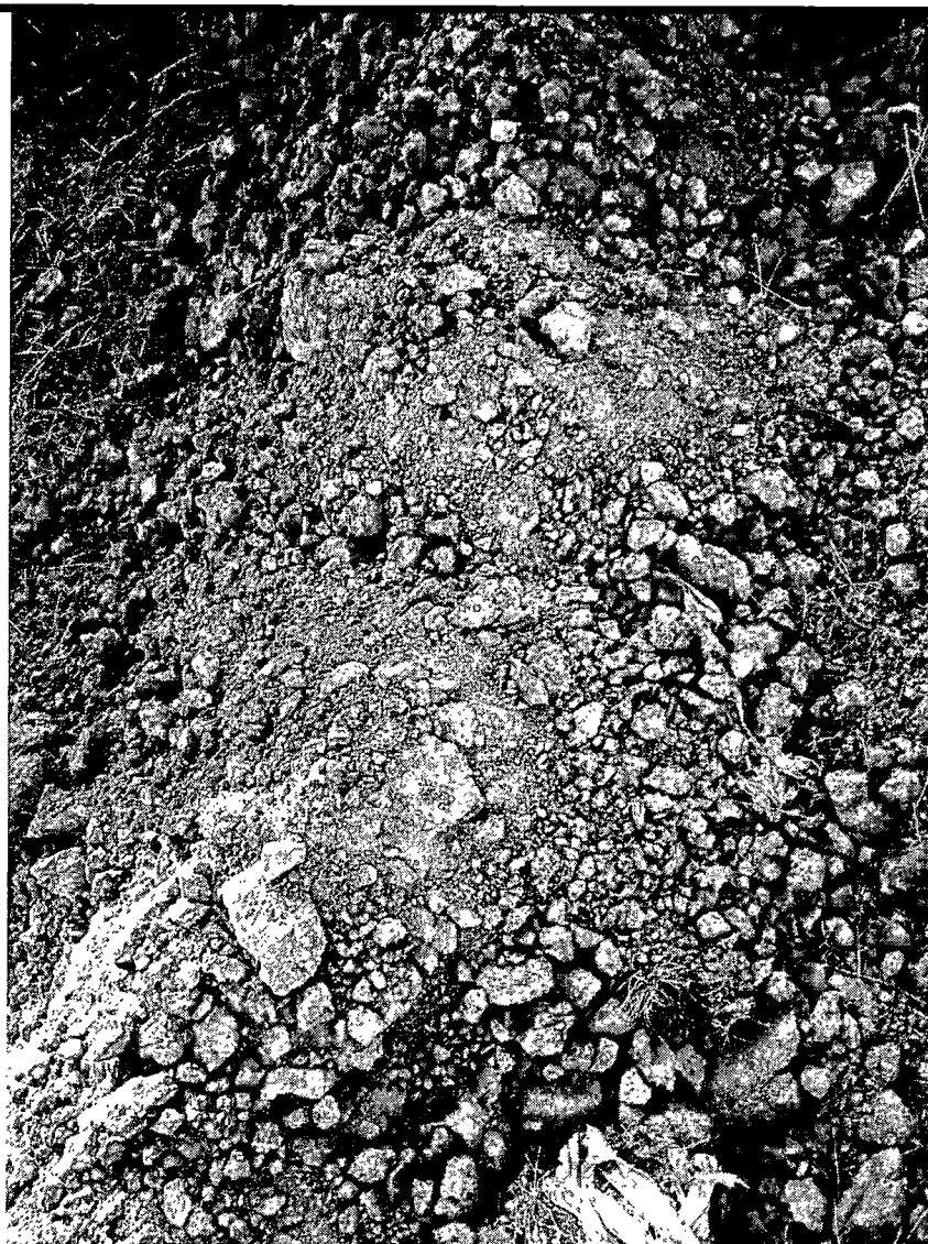
Fotografía 12 – Material de Excavación para posible relleno de zanja.
