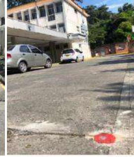
Materialización GPS02 – Intersección de parqueadero motos
