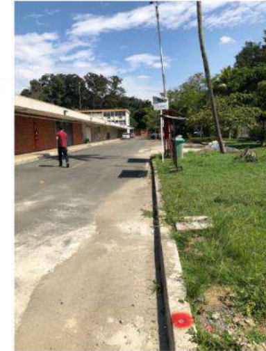
Materialización GPS01 – Ubicado sobre sardinel de vía interna
