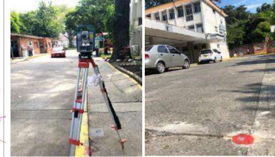
Materialización GPS02 - Intersección de parqueadero motos
