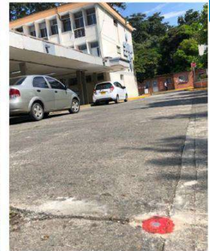
Materialización GPS02 – Intersección de parqueadero motos
