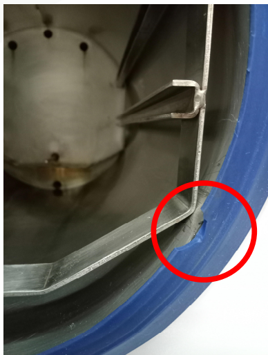
Empaque con fisura
