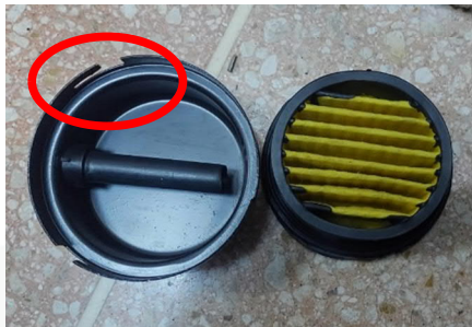
Soportes de filtro de compresor fisurado
