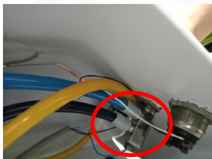
Fuga en módulo eyector
