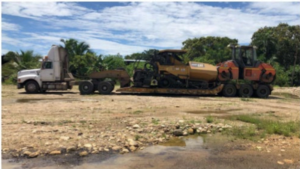
FINISHER Y COMPACTADOR DE ASFATO FECHA DE LLEGADA A OBRA 2-09-2021
