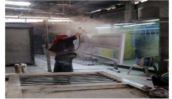
APLICACIÓN PINTURA ELECTROSTATICA PUERTAS METALICAS
