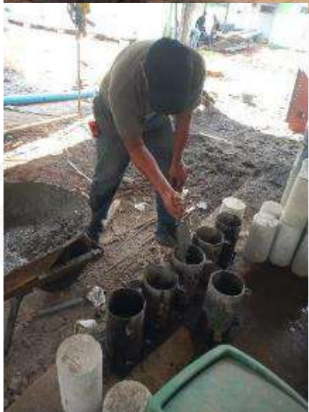
toma de cilindros placa tanque
