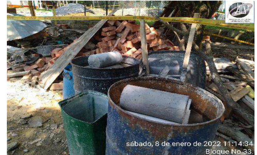
FRAGUADO DE ESPECIMENES DE CONCRETO ESTRUCTURA BLOQUE 33
