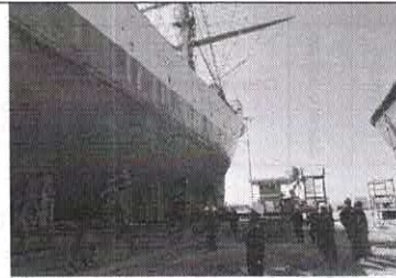
Inspección y limpieza del casco
