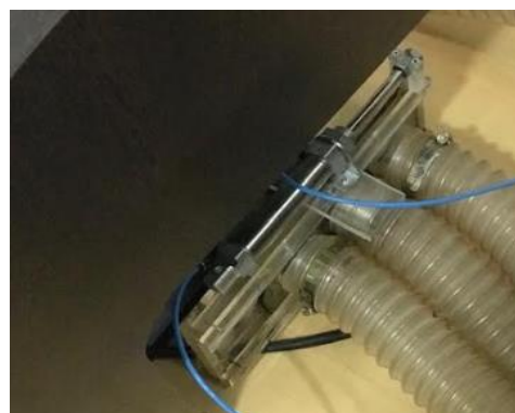
Se ajusta válvula de transporte.
