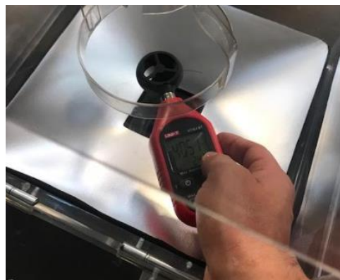
Se monitorea velocidad de ventiladores.
