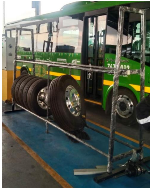
Imagen 19. Estantería para rines y llantas Esquema de ejemplo
