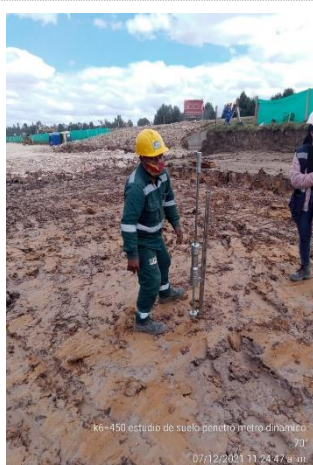
USO DEL PENETROMETRO DINAMICO DE CONO K 6+450 VARIANTE DE ZIQUAIRA
