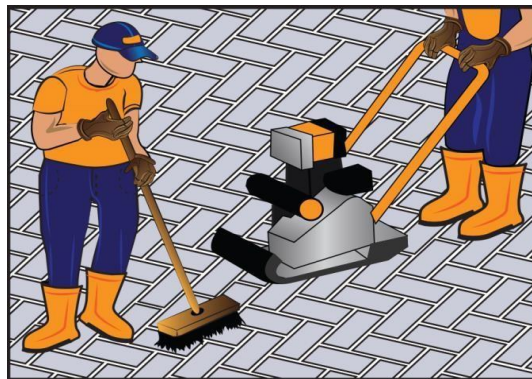
Figura 16. Sellado de juntas
