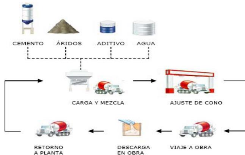
Figura 2 Flujograma del proceso, incluido el transporte
