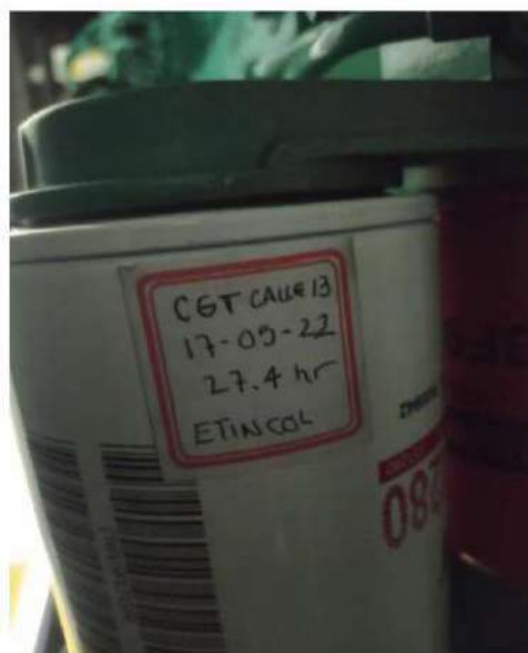
(Imagen3). Cambio filtro de combustible FS1280
