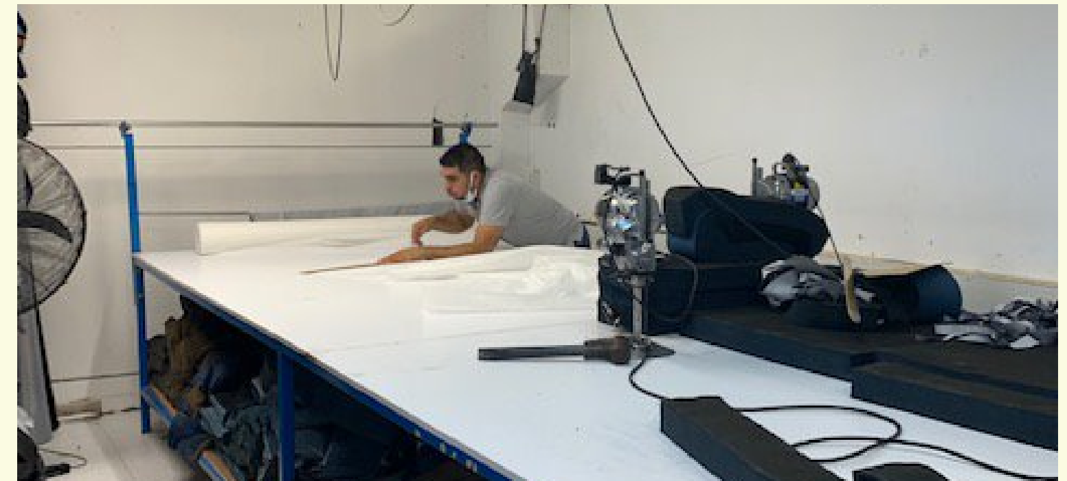
Nota: Trazado manual sobre tela para elaboración de prototipo.
