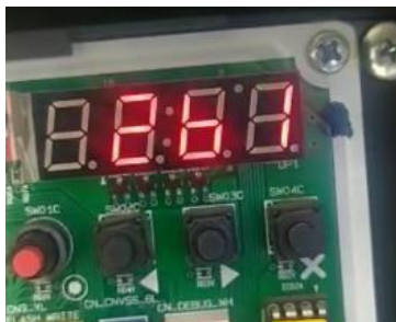
IMAGEN 8 ERROR PRESENTADO EN UNIDAD EXTERIOR
