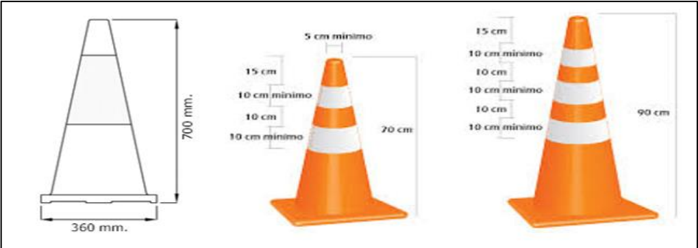
Ilustración 4: Especificación para la señalización con conos
