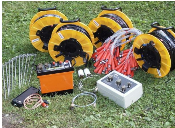
Figura 1 Equipo de tomografía eléctrica de resistividad ABEM TERRAMETER SAS 1000 con sistema Lund (Tomografías continuas).
