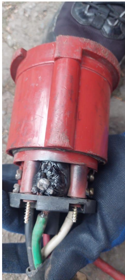
Imagen compartida por el Ingeniero Helver Correa, Jefe Técnico de Unidad Móvil, daño eléctrico en un conector
