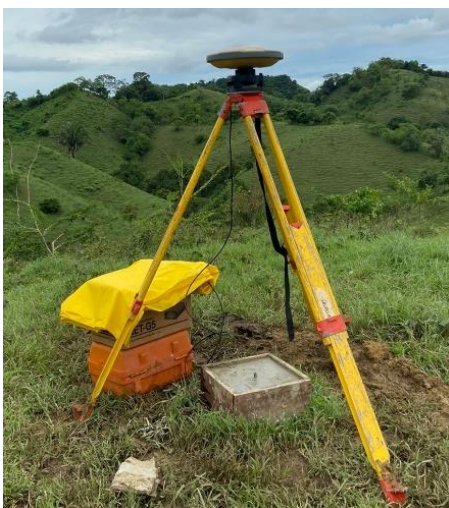
Imagen No. 44. Posicionamiento a través de GPS de doble frecuencia de vértices geodésicos de 4to orden. Fuente propia.
