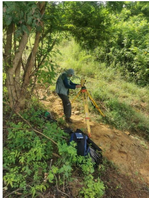
Imagen No. 45. Levantamiento de puntos de interés geocientífico, desde poligonal topográfica. Fuente propia.
