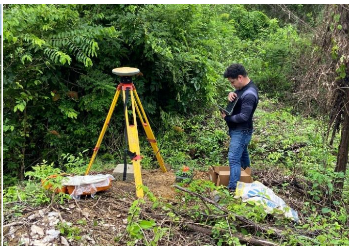
Imagen No. 44. Posicionamiento a través de GPS de doble frecuencia de vértices geodésicos de 4to orden. Fuente propia.
