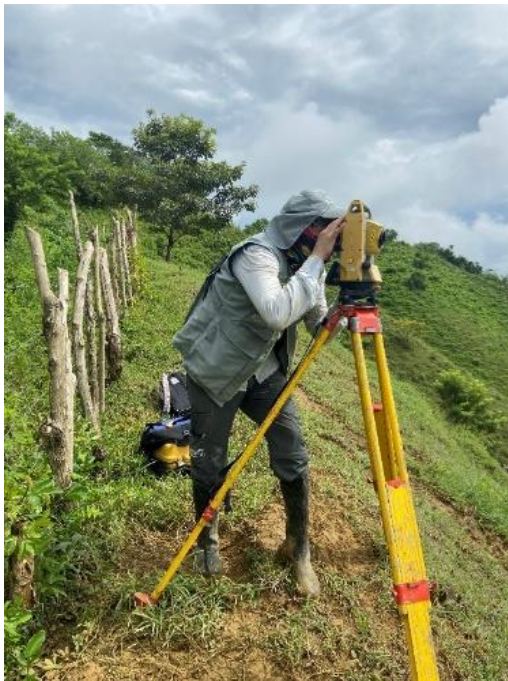
Imagen No. 45. Levantamiento de puntos de interés geocientífico, desde poligonal topográfica. Fuente propia.
