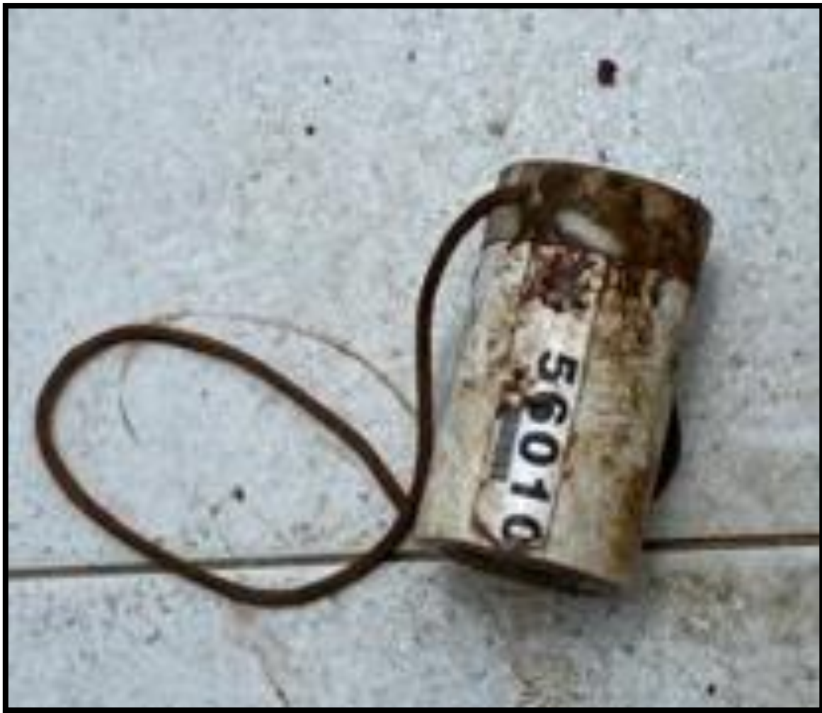
Imagen No. 81. Electrodo de serial 56010 dañado. Fuente propia.
