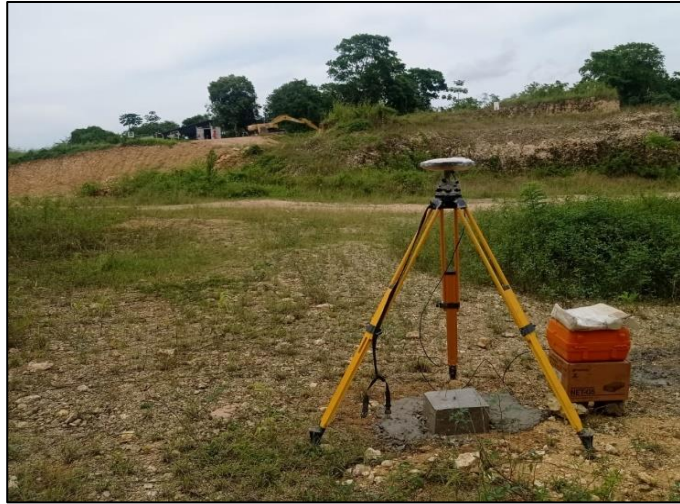
Imagen No. 37. Posicionamiento geodésico de vértices para el amarre de poligonal topográfica. Fuente propia.
