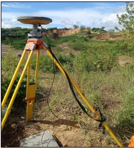
Imagen No. 37. Posicionamiento geodésico de vértices para el amarre de poligonal topográfica. Fuente propia.
