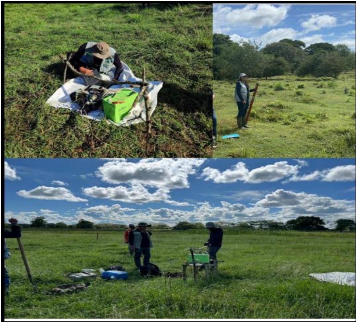
Imagen No. 50. Puesta en sitio de equipos de medición magnetotelúrica. Fuente propia.
