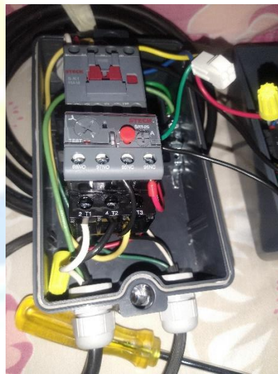
Configuración y cableado del arrancador directo
