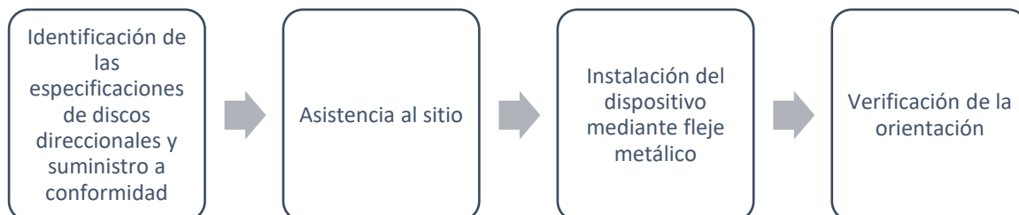
Gráfico 1: Proceso en la instalación de discos direccionales
