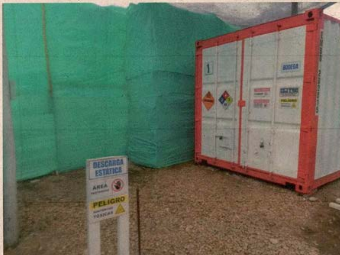
Ilustración 19 Descarga Estática, Señalización y Seguridad con Doble Candado de las estructuras Portátiles para Almacenamiento de Material Pirotécnico incautado
