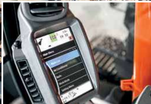
El monitor LCD muestra el estado y la configuración de la máquina.
