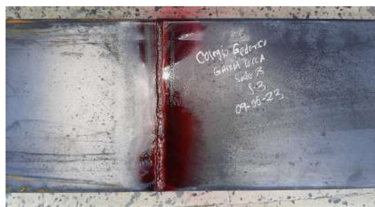
APLICACIÓN DE PENETRANTE
