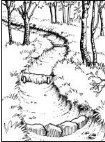
Figura 82. Diques de contención.
