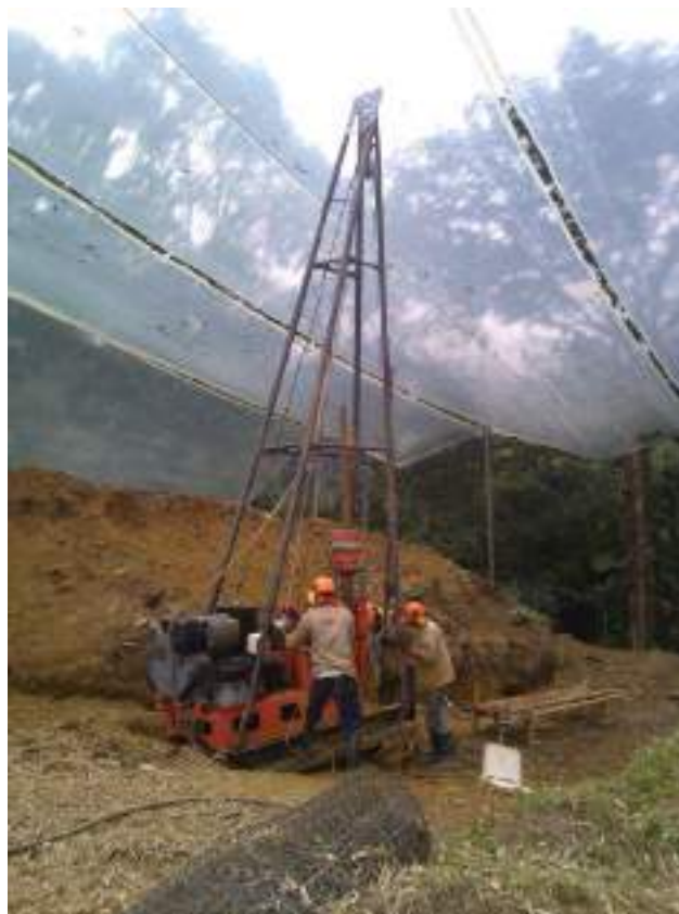
Figura 2. Procedimiento para la realización de perforaciones exploratorias mediante rotación con broca de diamante.
