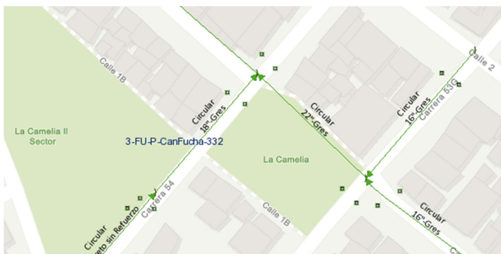
Figura 41. Redes de alcantarillado pluvial cercanas.
