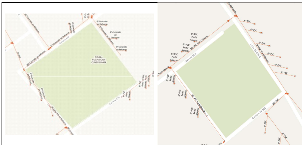
Figura 51. Redes de alcantarillado sanitario.
