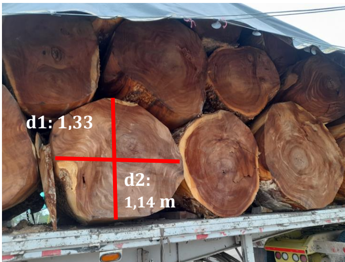
Fotografía 2. Metodología para el cubicaje de madera Rolliza.
