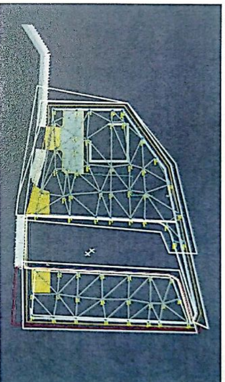
Figura 1: Superficie TIN para relleno de caliche y subbase. Fuente: elaboración propia a partir de software Civil 3D.
