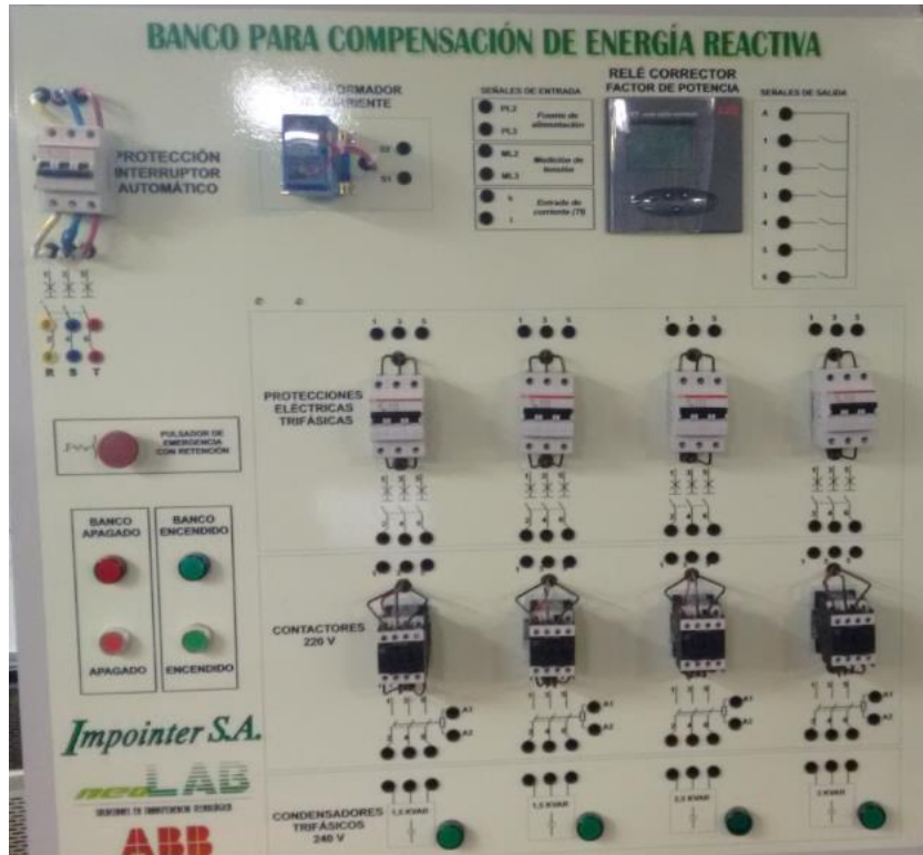
Figura 1. Banco para compensación de Energía Reactiva.
