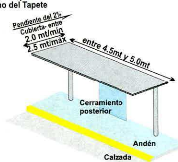
Disposición fachada/cerramiento posterior
