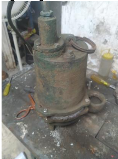
Imagen. Bomba Centrífuga de Aguas Negras del Centro Cultural “Guillermo Barney Materón”
