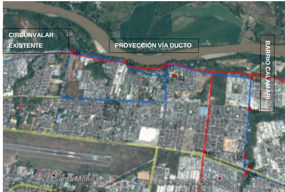
Ilustración 8 En color rojo (Los puntos donde se intersectan los trazados de la circunvalar de Oriente según P.O.T. vigente en color azul el nuevo trazado).
