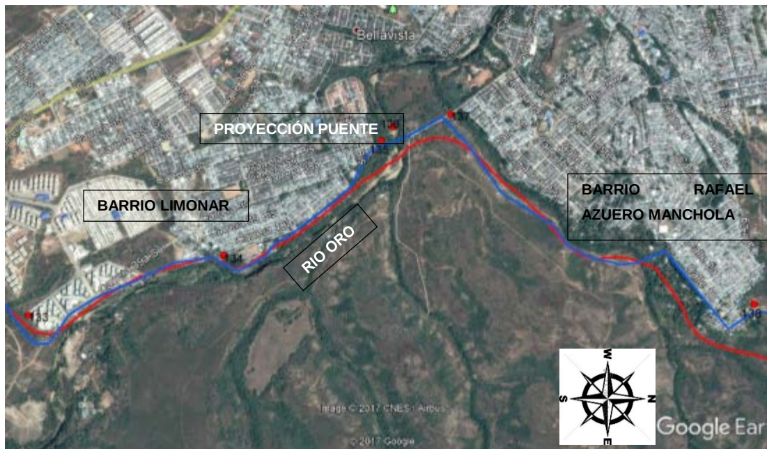
Ilustración 4 En color rojo (Los puntos donde se intersectan los trazados de la circunvalar de Oriente según P.O.T. vigente y los proyectados, se traza en color azul, de acuerdo a recorrido de campo).
