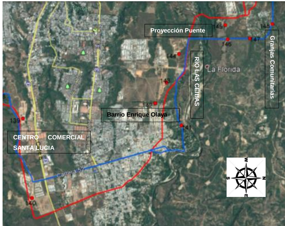
Ilustración 5 En color rojo Alternativa 2 (Los puntos donde se intersectan los trazados de la circunvalar de Oriente según P.O.T. vigente y los proyectados, la cual cruza la Carrera 56. En azul alternativa 1, la cual cruza la Carrera 52.
