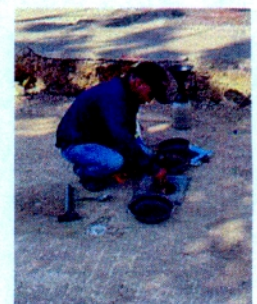
COMPACTACIÓN DE SUB BASE CON EQUIPO VIBROCOMPACTADOR Y TOMA DE DENSIDADES
