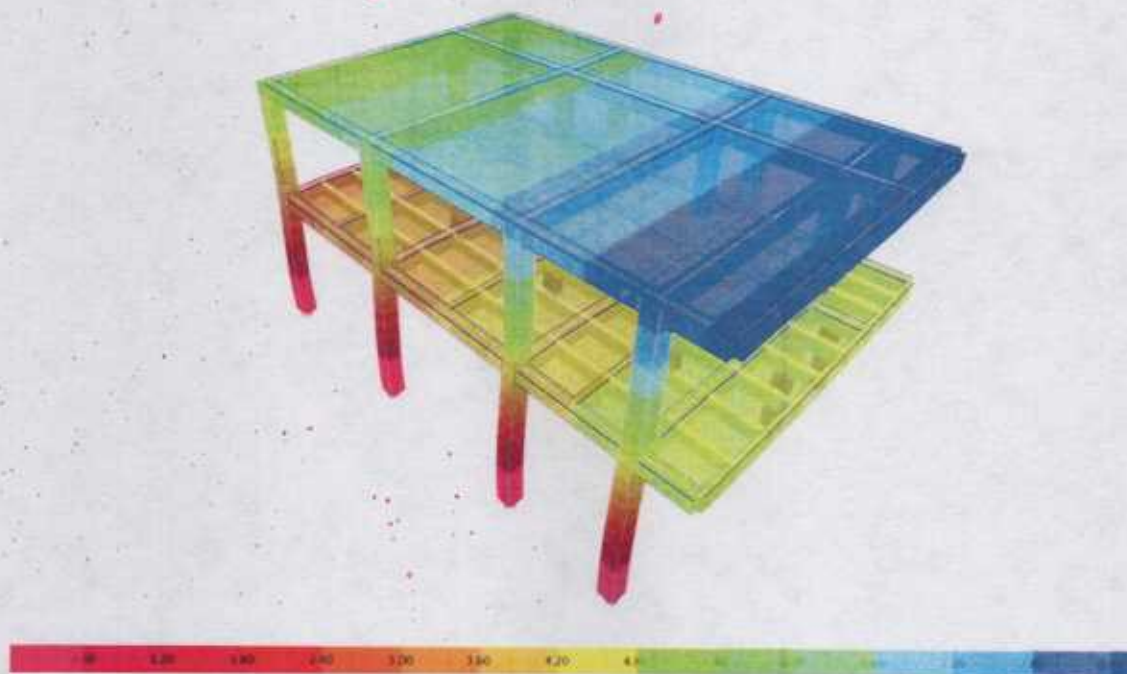
Figura 8-5. Desplazamiento debido a umbral de daño X (mm)
