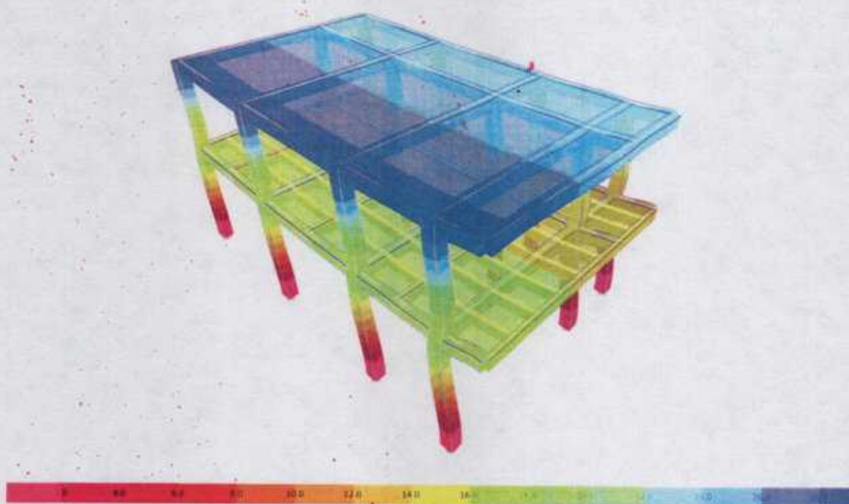
Figura 8-3. Desplazamiento debido a sismo Y (mm)
