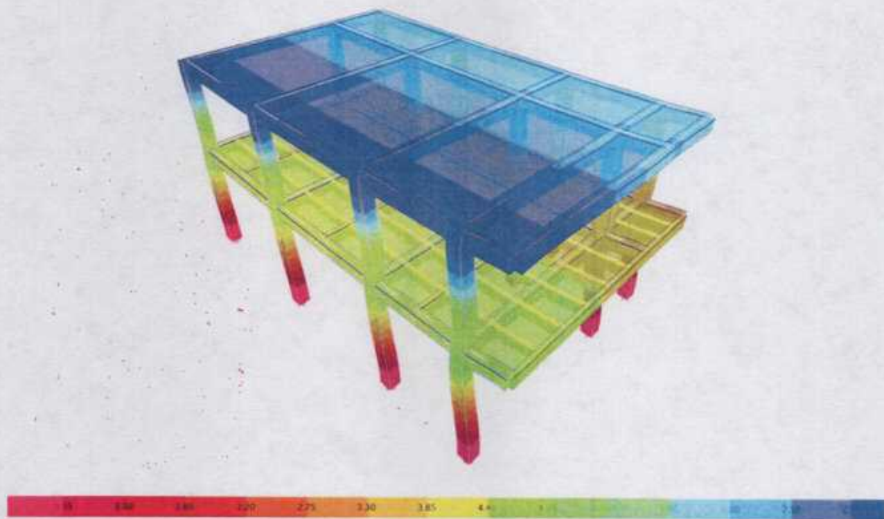
Figura 8-7. Desplazamiento debido a umbral de daño Y (mm)
