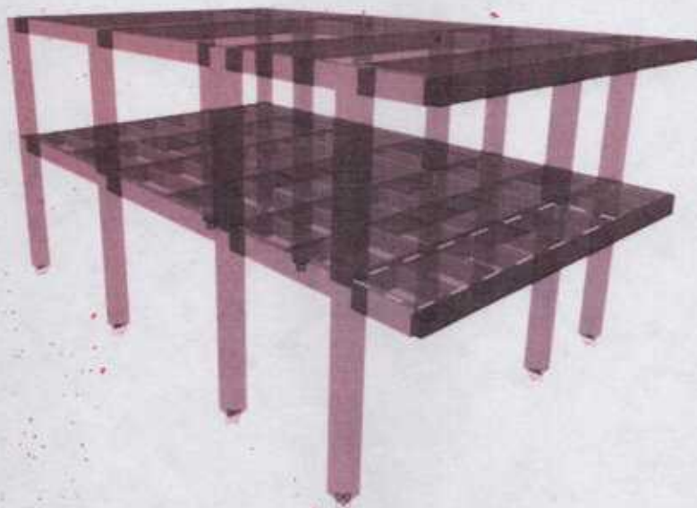
Figura 7-1. Vista 3D de modelo en elementos finitos
