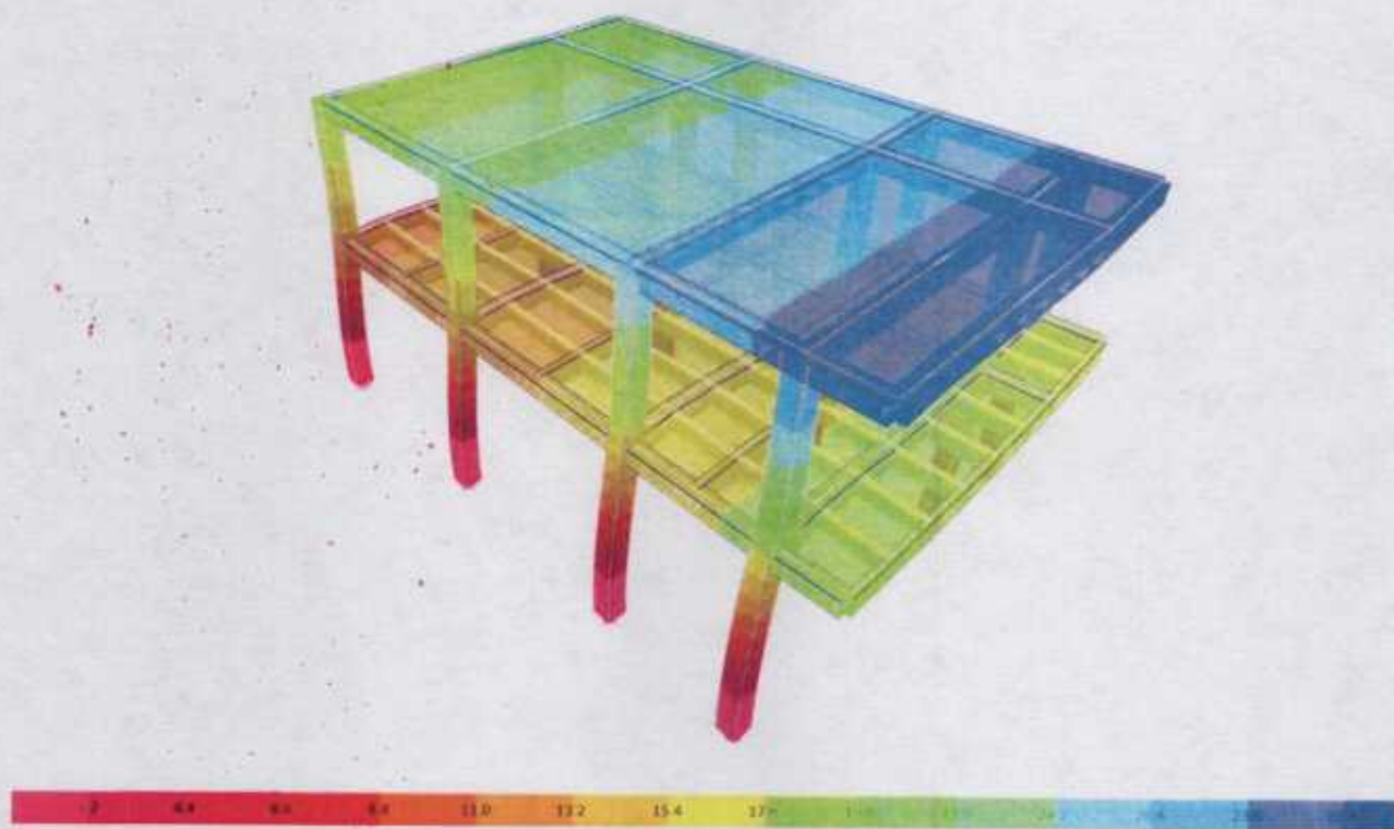
Figura 8-1. Desplazamiento debido a sismo X (mm)
