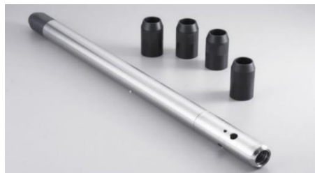
Fotografía 5. Accesorios para la realización del ensayo de penetración estándar (SPT).
