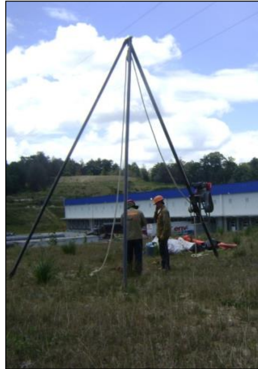
Figura 1. Procedimiento para la realización del ensayo de penetración estándar (SPT).
