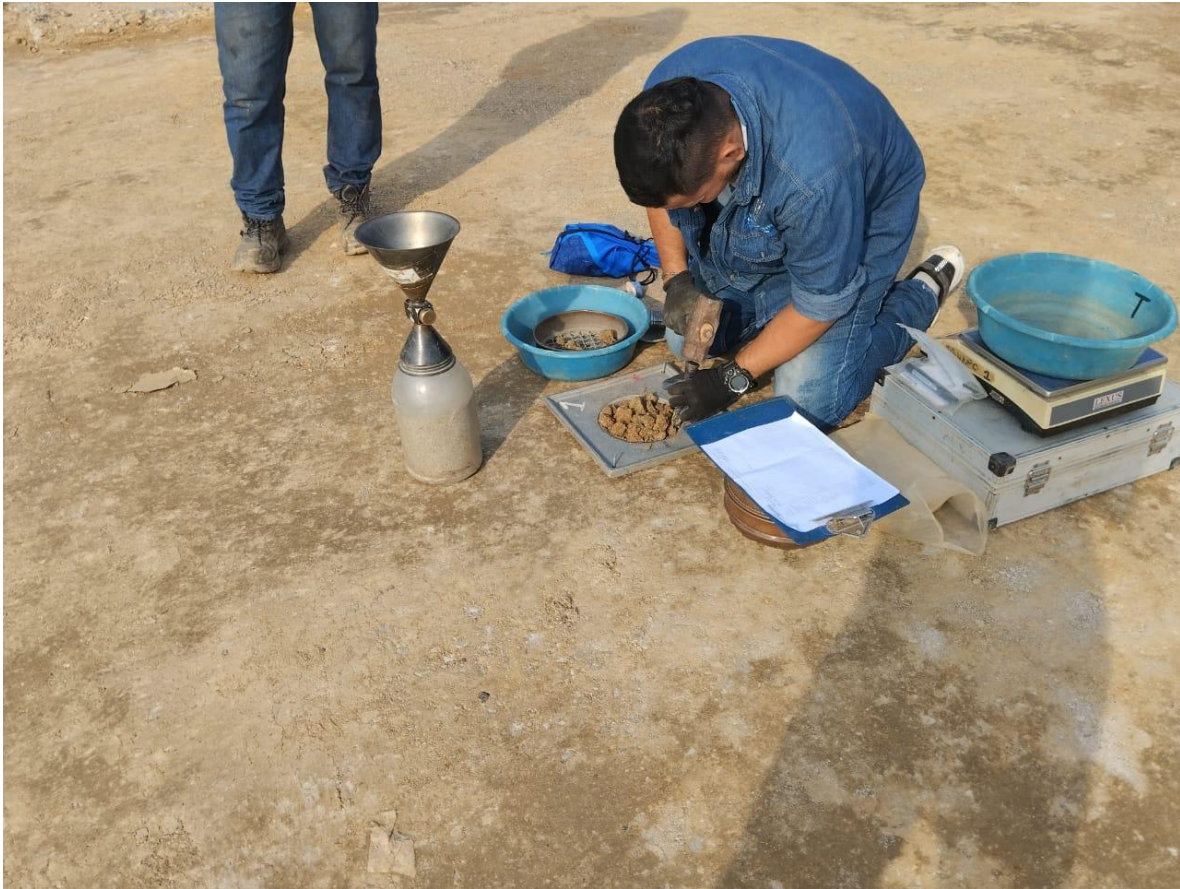
Ilustración 12. Toma de densidades para porcentaje de compactación. Fuente Autores.
