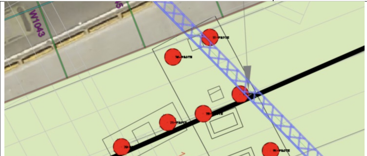
Interferencia ETB Existente Pilotes 77 y 79, Separador Central
