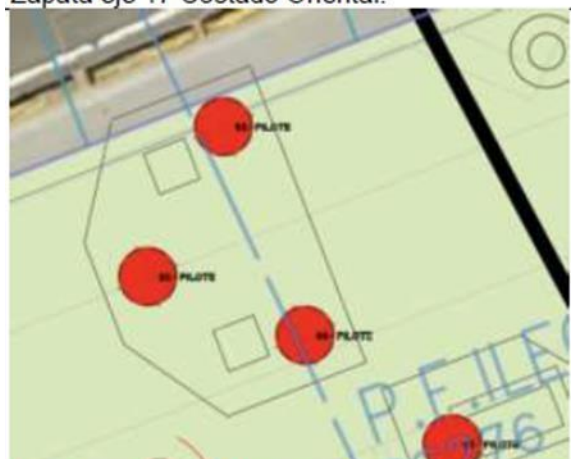
Interferencia CODENSA existente Pilotes 63 y 64. Separador central
