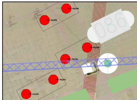
Interferencia Pilote 118 con red de ETB
