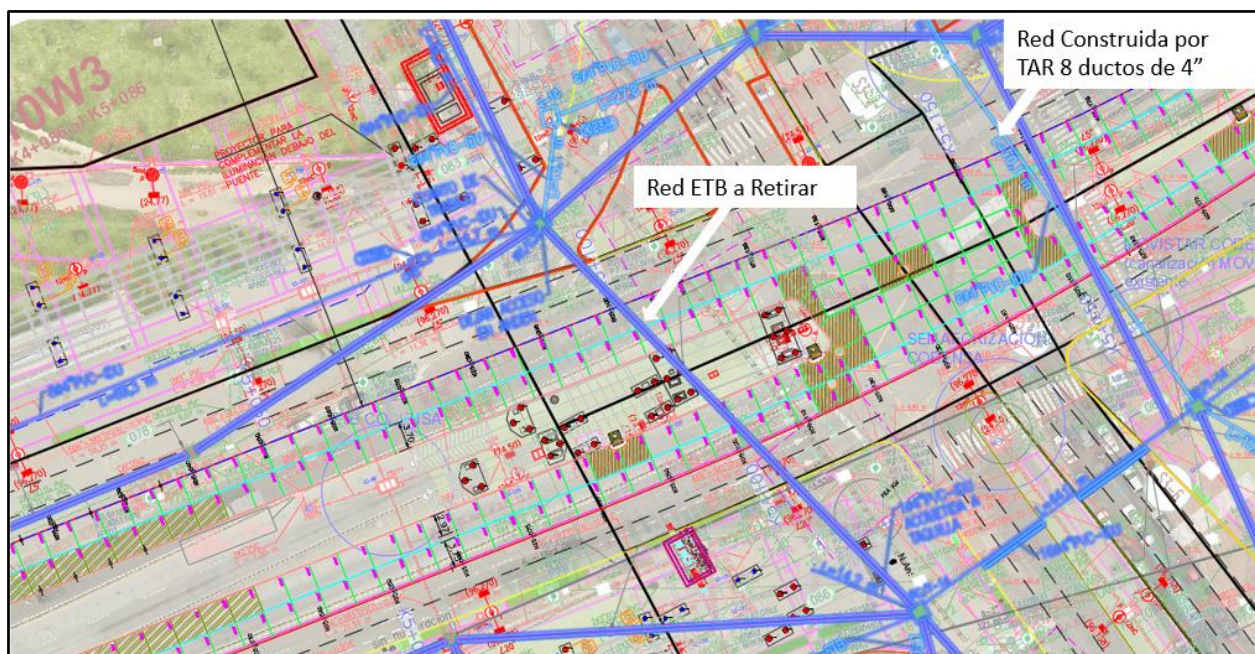
Panorama general de Interferencias Red de ETB" con Pilotaje del Puente Peatonal
