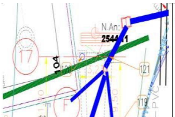
Interferencia CODENSA Existente Pilote 121, Zapata eje 17 Costado Oriental.
