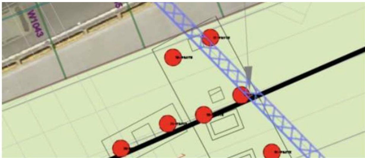
Interferencia ETB Existente Pilotes 77 y 79, Separador Central
