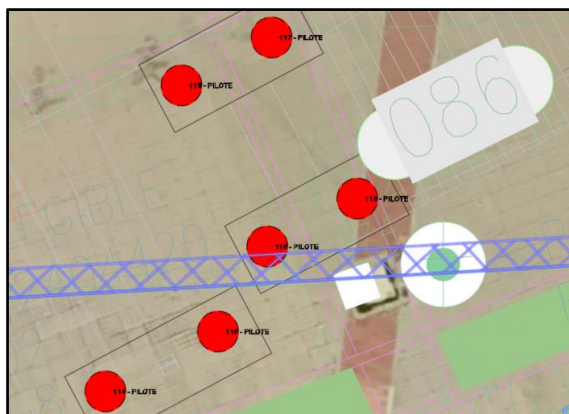
Interferencia Pilote 118 con red de ETB
