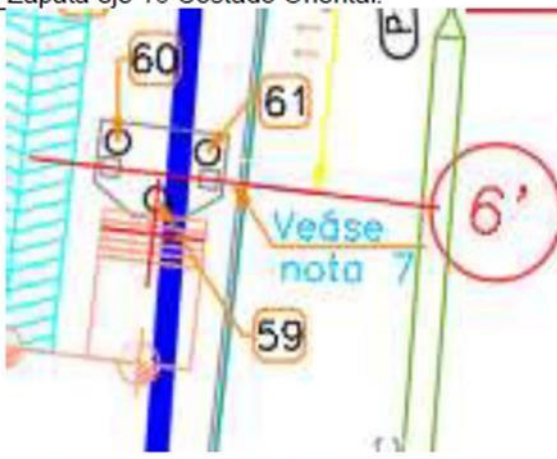
Interferencia CODENSA Existente Pilotes 59 Zapata eje 6' Separador Central.
