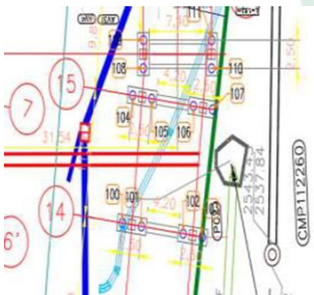
Interferencia posible red de Movistar instalada por TAR. Pilotes 103 y 107, Zapatas eje 14, 15 Costado Oriental.
