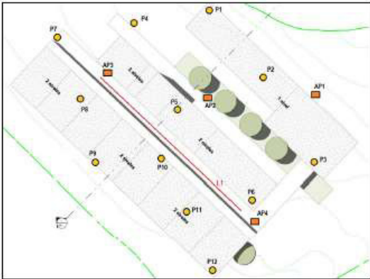
Figura 2. Localización de sondas exploratorias
