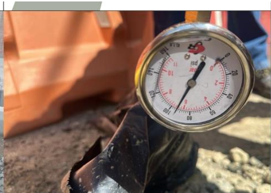
Foto 10: PRUEBA HIDROSTATICA EN ALCAZARES
