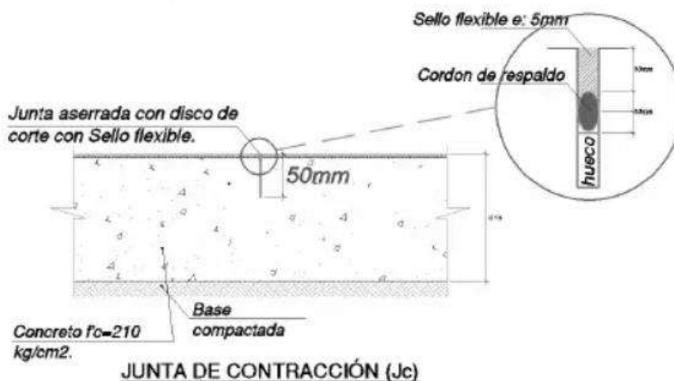
Ilustración 5. Esquema de junta de contracción
