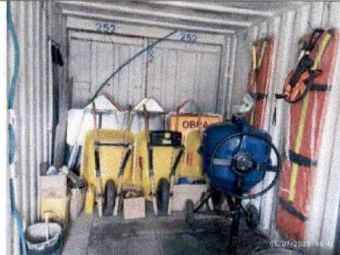
Fotografía 8. Se organiza la señalización, concretadora, caretillos y demás herramientas dentro del contenedor para resguardarlos mientras el frente de obra se reactiva.
