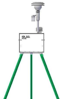
Figura 4. Equipo de monitoreo de bajo volumen (PM2.5 y PM10)
