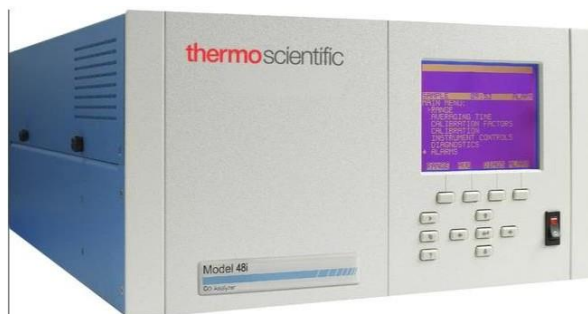
Figura 6. Equipo Thermo Scientific infrarrojo no dispersivo para monóxido de carbono. Modelo 48
