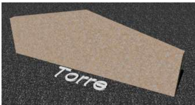
FIGURA N° 4: Detalle de Placa denominado "Torre" utilizado en los diseños arquitectónicos a manera de cumbrera o remate de muros con dos
