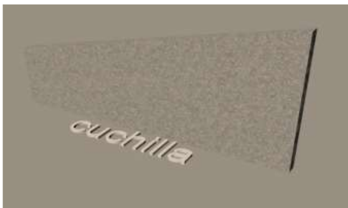
FIGURA N° 3: Detalle de Placa denominado "Cuchilla" Utilizada comúnmente en techos con una caída o también denominada "un agua"
