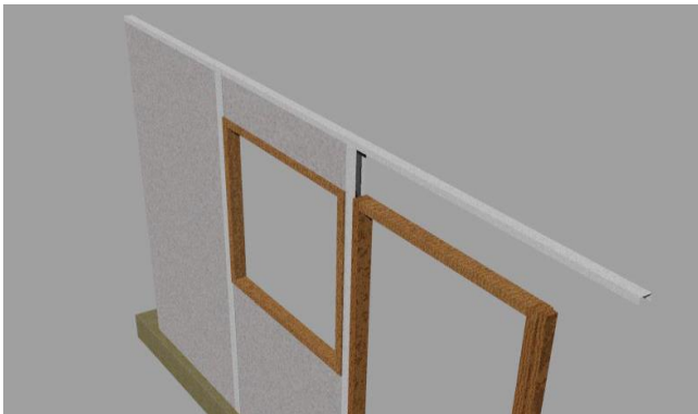
Detalle de perfil de enrase superior
